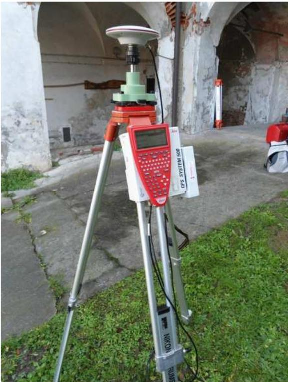
orientale. Queste due parti non sono interscambiabili fra loro e la comunicabilità è limitata, perciò è stato scelto di rilevare con una tecnologia GPS<sup>3</sup> i quattro punti, di cui due (una base) nel cortile e due (una seconda base) all'esterno del convento, a est (le altre basi collegano reciprocamente i vertici per formare la rete topografica).
