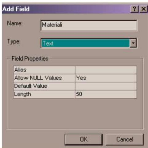
Finestra di dialogo per l’introduzione di un campo aggiuntivo al database spaziale già automaticamente creato in ambiente GIS; è necessario specificare il tipo di campo (numerico, testo...) e la lunghezza richiesta.
